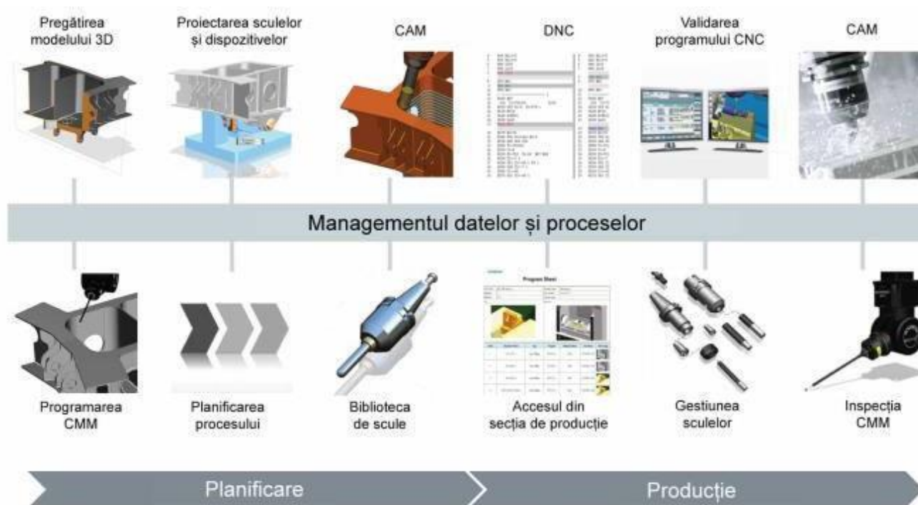
Fig. 1.8. Exemplu de integrare a proceselor într-o platformă smart manufacturing [13]
