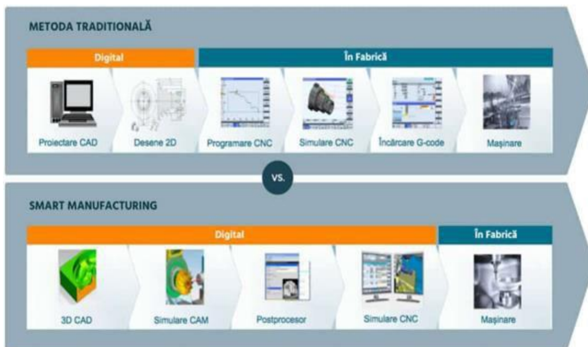
Fig. 1.6. Evoluția proceselor de fabricație în fluxul clasic și în varianta smart manufacturing [13]
